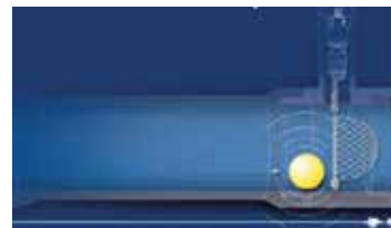
Introduction d'un hydrophone libre Smart Ball® (source : Pure Technologies)
