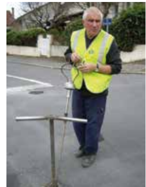
Réalisation d'une écoute directe mécanique (source : Irstea)
